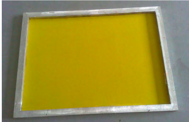
图 2 丝网印刷模板 Fig. 2. The template of screen printing.
